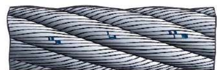
fils cassés au niveau des "parures"
