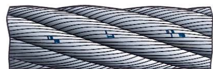
fils cassés au niveau des "parures"
